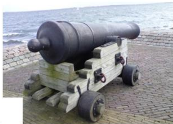
Gekozen constructie van rolpaard, met daarop een 36 ponds kanon
