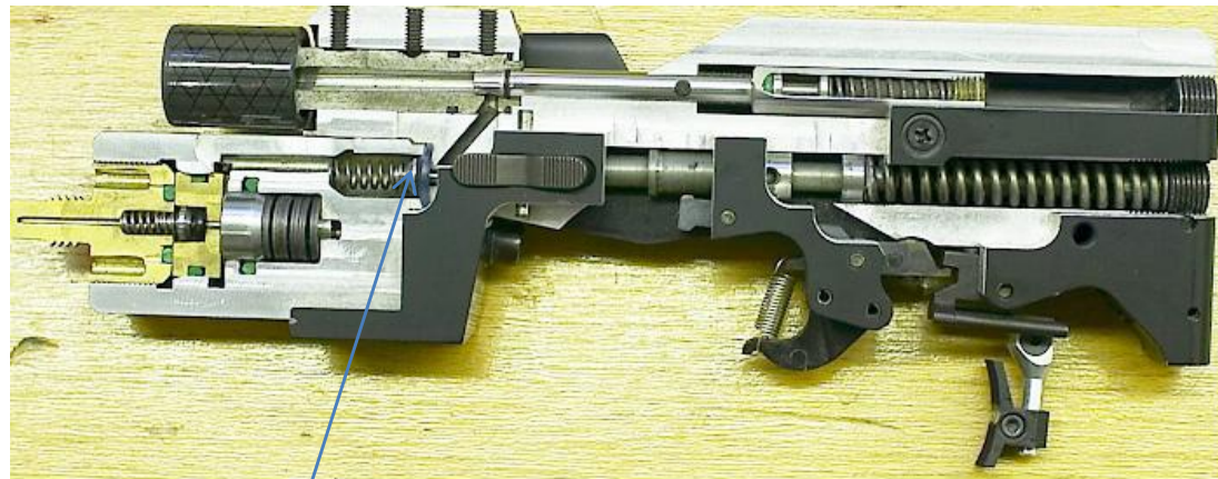
Afvoer mechanisme en ventiel voor toelaten perslucht achter de kogel van een modern persluchtdruk geweer ( Walther )
